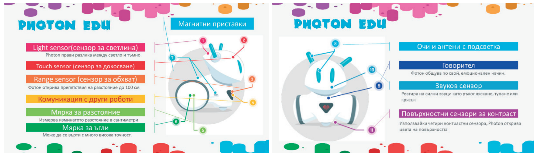
Фигура 1. Роботът Photon – описание на елементи и сензори.
