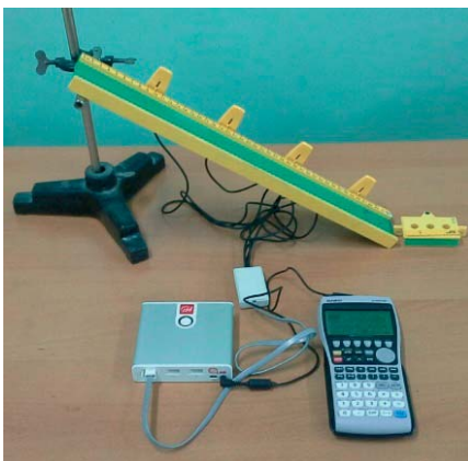
Рис. 2. Лабораторная установка по механике на основе CASIO fx-9860CII и CLab
